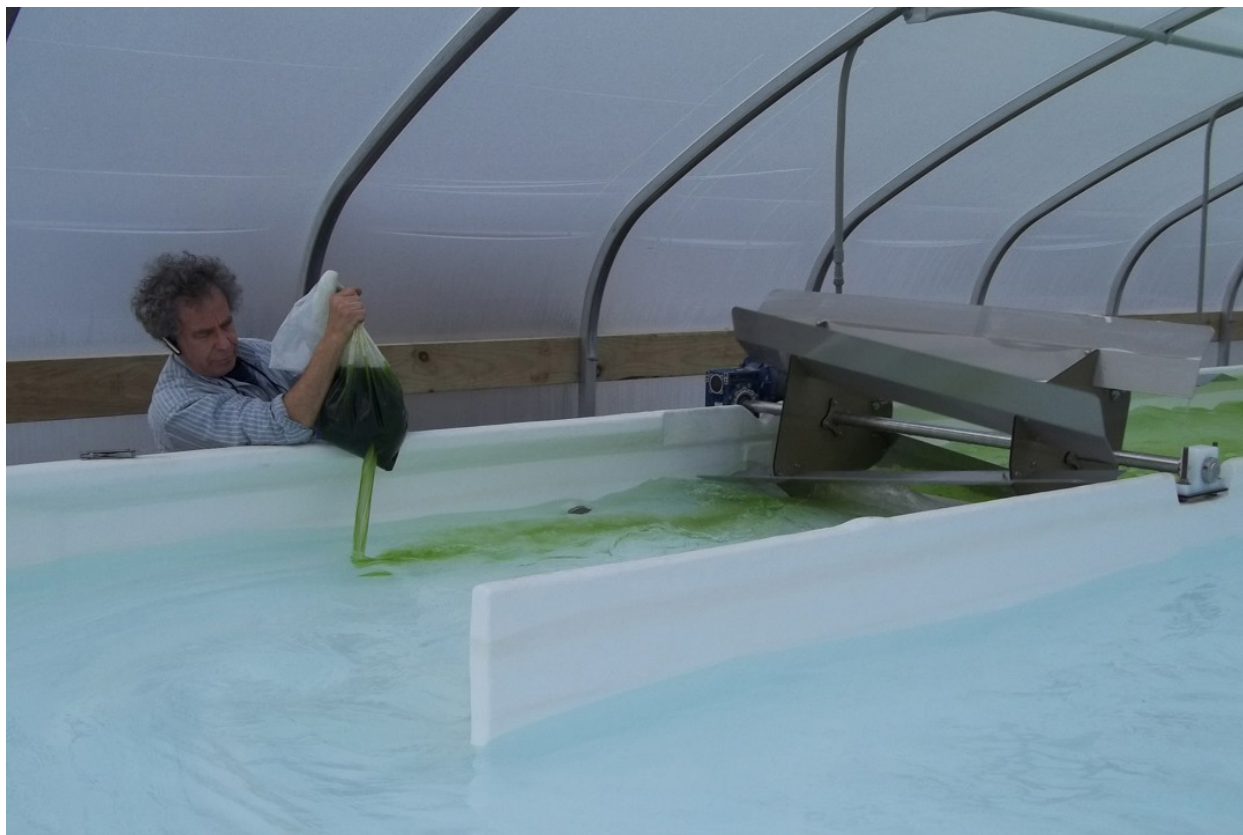
Inoculating the CHE raceway.
